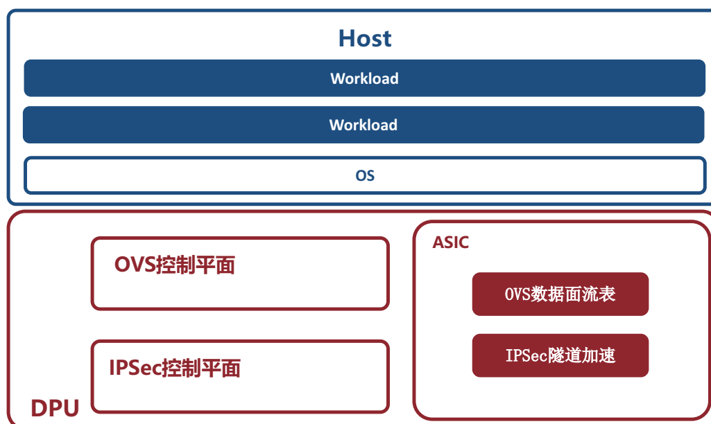
图 6.7: 基于 DPU 的 IPSec 隧道加速示意图
